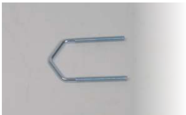
Třmen M8 rozteč 85mm, závit 60mm
