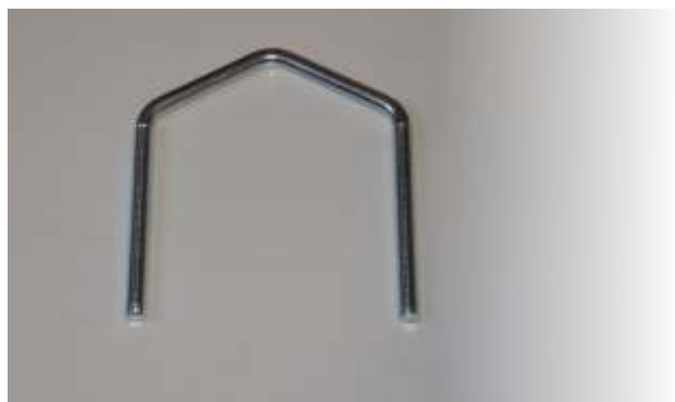
Třmen M12 rozteč 150mm, závit 80mm
