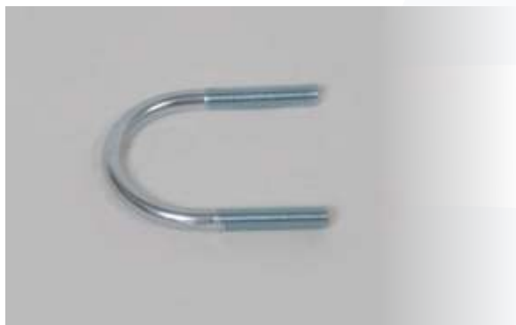
Třmen M10 rozteč 70mm, závit 60mm
